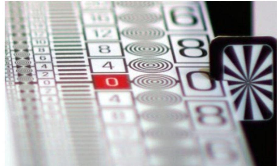
Mise au point derrière (backfocus)
